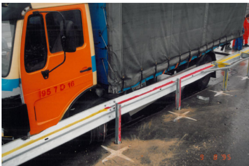
Bild 21: Fahrzeugschäden (linke Fahrzeugseite)
