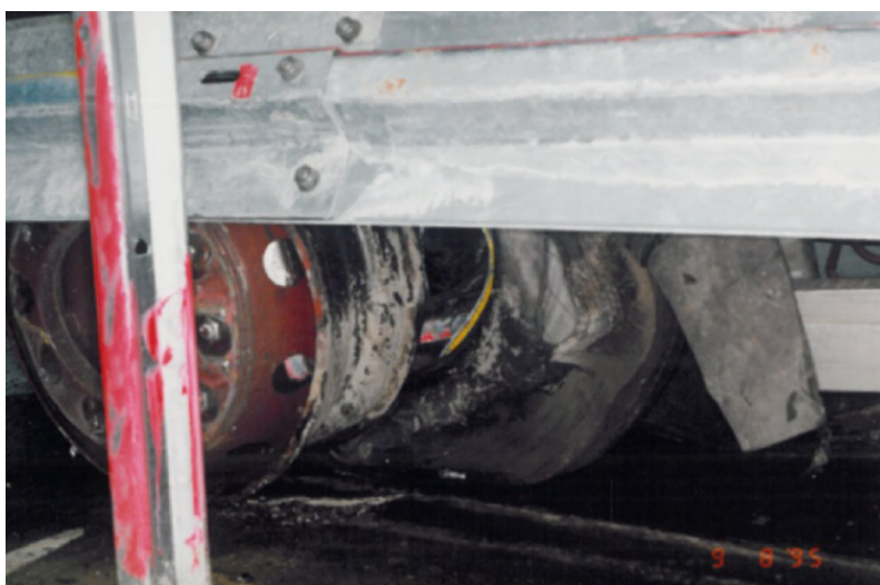
Bild 22: Fahrzeugschäden (Detail: linkes Vorderrad)
