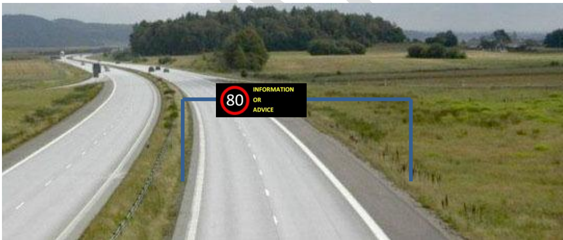
Abbildung 10: Am Portal montierte VSL Verkehrszeichen auf der Autobahn, ein Verkehrszeichen für Geschwindigkeitsbegrenzung integriert in die VMS.
