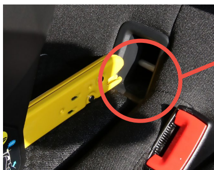
Fahrzeugseitiger Verankerungspunkt mit „i-Size“ Kennzeichnung: (Bilder: BASt)
