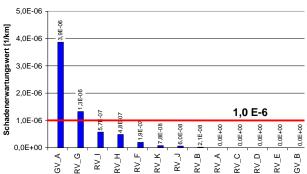
Bild 8: Kalibrierung EV-Grenzwert - reine Druckwirkung
