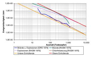
**Bild 17:** Stationäre Risiken aus Gefahrgut [RASM 1975], [GRS 1979]
