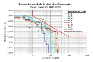
**Bild 23:** Vergleichende Gegenüberstellung von 10 im Rahmen von Gefahrgutanalysen mit quantitativen Methoden durchgeführten Risikoberechnungen
