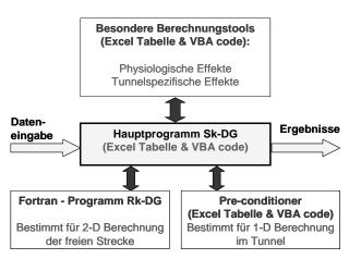
Bild 2: Funktionsschema OECD/PIARC Modell
