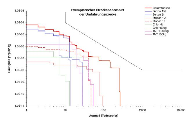
Bild 33: Summenkurven für den untersuchten Streckenabschnitt unter Berücksichtigung der zusätzlichen Gefahrguttransporte
