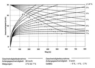
**Bild 1:** Geschwindigkeitsprofile für Schwerfahrzeuge in Abhängigkeit der Längsneigung - Ausschnitt 0 - 800 m [HBS 2001]
