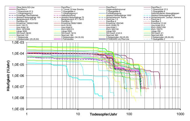
Bild 3: Ergebniszusammenstellung 68 Varianten zur Sensitivitätsprüfung des OECD/PIARC QRAM
