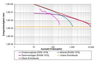
**Bild 16:** Stationäre Risiken aus Nicht-Gefahrgut [RASM 1975], [GRS 1979]
